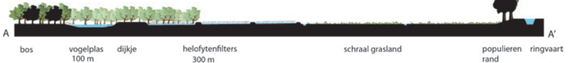
Doorsnede van het noordelijke zuiveringspark. De open zone van het landschap wordt niet aangetast door de nieuwe functie.
