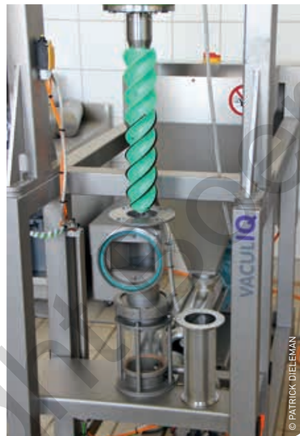
De doorzichtige cilinder onderaan is het hart van de spiraalfilterpers. Daarin komt de inox filter (die hier rechts ervan staat). Tijdens het persen draait de groene vijzel erin rond om het sap door de filter te persen.
