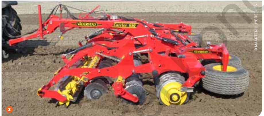
1 De TopDown is multifunctioneel inzetbaar. Je hebt slechts één werktuig nodig voor meerdere toepassingen. De aankoopprijs is navenant. 2 De Carrier is een compactschijveneg met vooraan een snijmolen. Deze cutter snijdt het 'droge' gewas alvorens het door de schijveneg nog eens verwerkt wordt. De vertering versnelt en de mogelijke verstoppingen worden gereduceerd.
