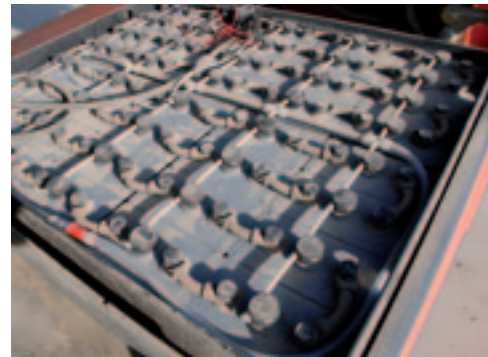
▲ De 80 volts accu weegt 1.863 kg De accu van de E35 is samengesteld uit 40 batterijen van elk 2 volt.
