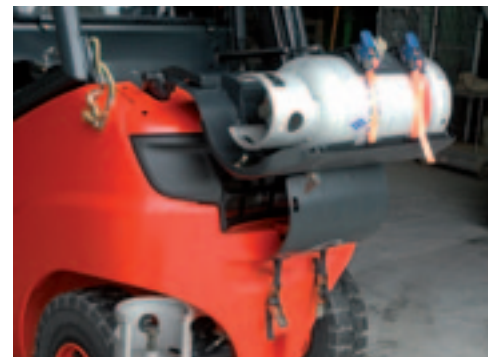
▲ Twee gasflessen achterop met lpg Het gebruik van twee flessen (met een T-kraan om te zetten) verlengt de rijtijd.
