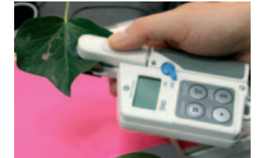
^ Spadmeter Een spadmeter meet het chlorofylgehalte in blad, een maat voor de stikstofopname.
