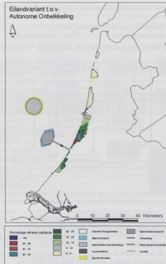
Figuur 3.4 Procentuele verandering in de saltspray langs de Nederlandse kust voor de variant 'Groot' t.o.v. autonome situatie.
