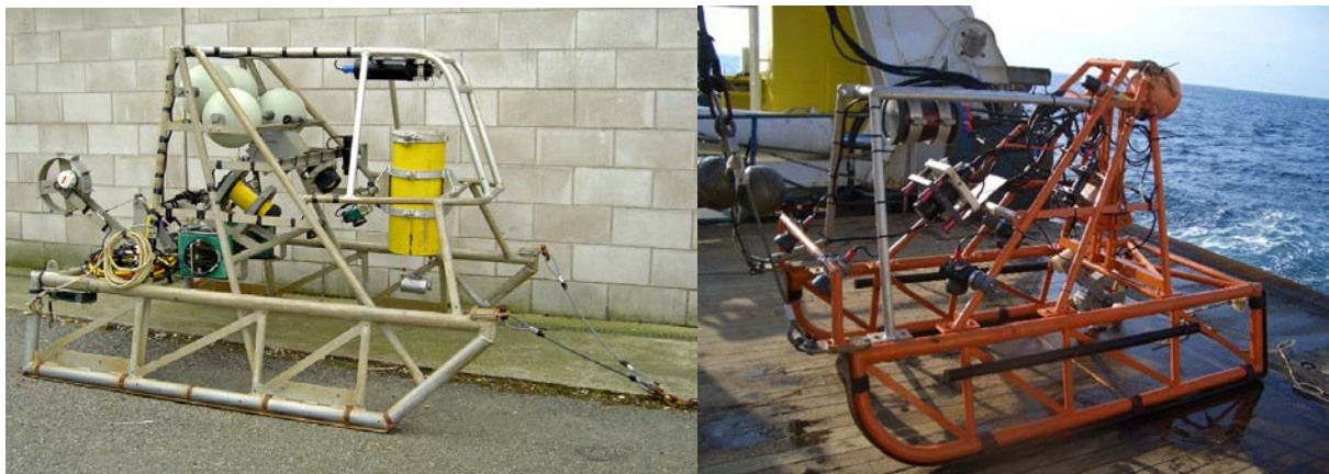
Figure 10. UWTV sledges used, left MSS, right CEFAS.
