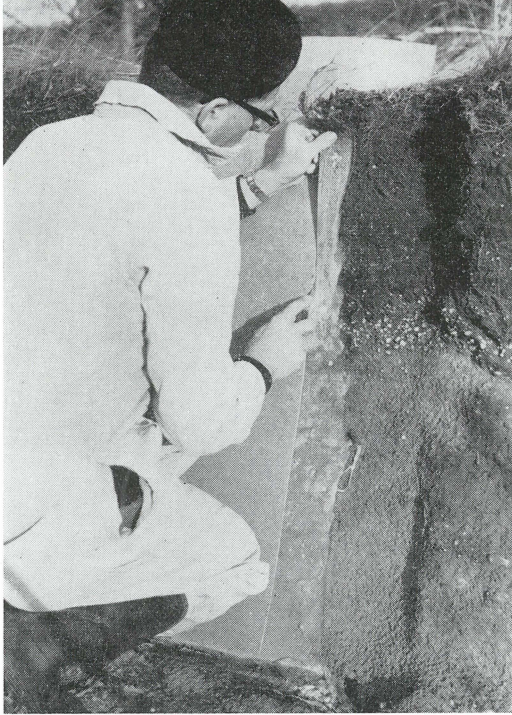
De lakfilm wordt langs een plaat hardboard op maat gesneden en de overtollige stroken verwijderd. Vervolgens wordt de lakfilm (foto rechts) afgenomen. De bovenzijde wordt losgetrokken, stevig tegen de plaat board gehouden en langzaam achterover getrokken.
