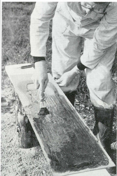
Van links naar rechts: een tweede boardplaat wordt dik met profiellak ingesmeerd; de lakfilm wordt overgebracht van de eerste op de tweede plaat; daarna wordt de lakfilm vanuit het midden voorzichtig aangedrukt.
