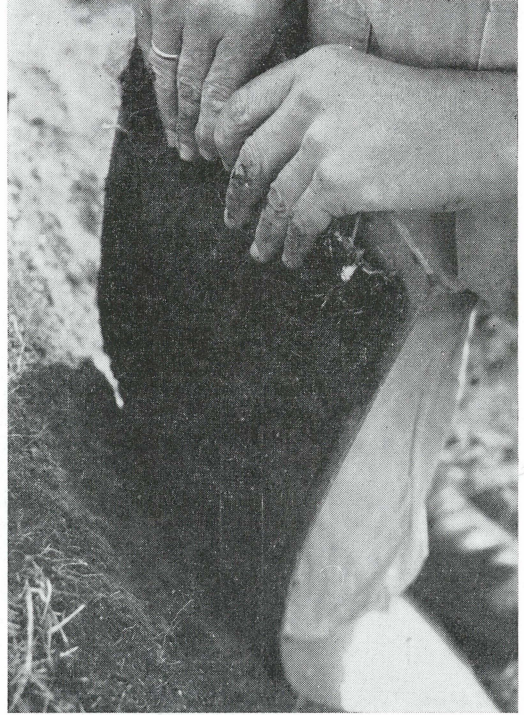
De lakfilm wordt langs een plaat hardboard op maat gesneden en de overtollige stroken verwijderd. Vervolgens wordt de lakfilm (foto rechts) afgenomen. De bovenzijde wordt losgetrokken, stevig tegen de plaat board gehouden en langzaam achterover getrokken.
