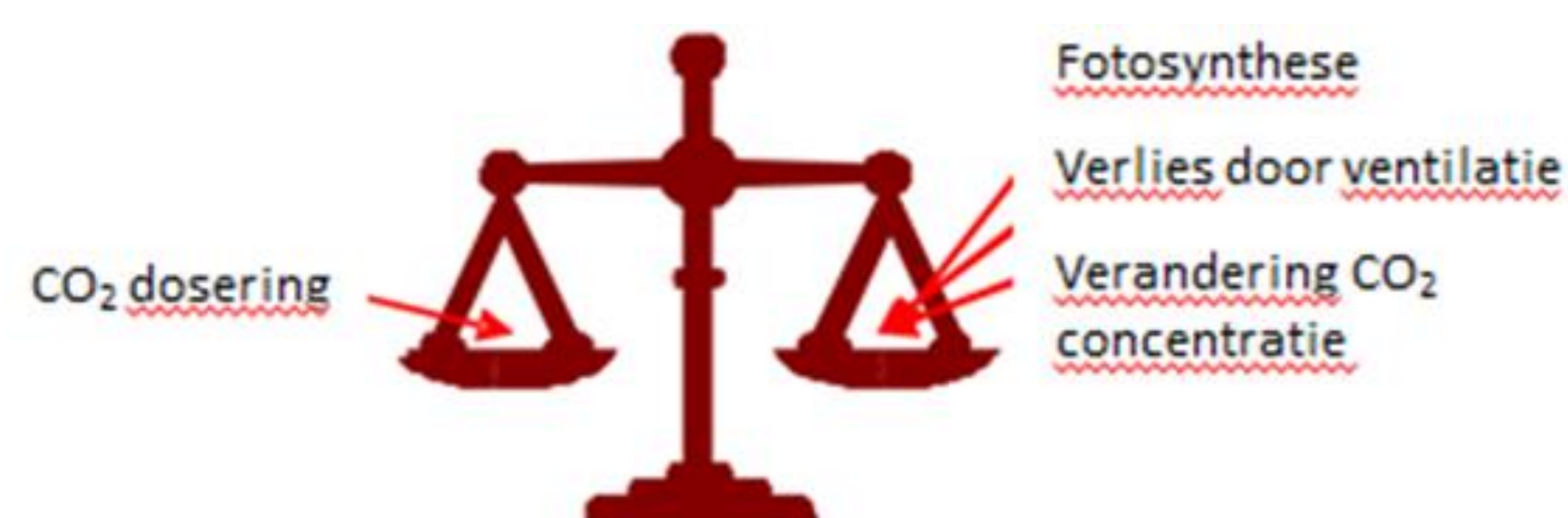
Figuur 1. CO 2 balans van de kas als basis voor de berekening van de fotosynthese van het hele gewas.
