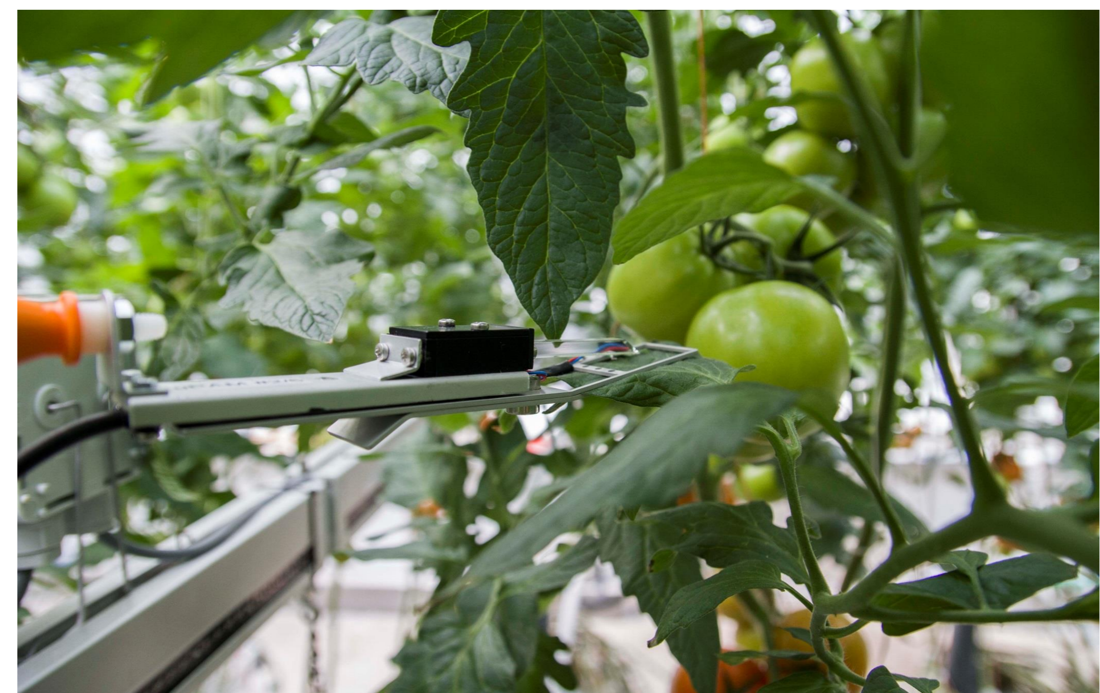
Figuur 3. Een Micro-Moni-PAM fluorescentiesensor met geïntegreerde PAR sensor in een tomatengewas
