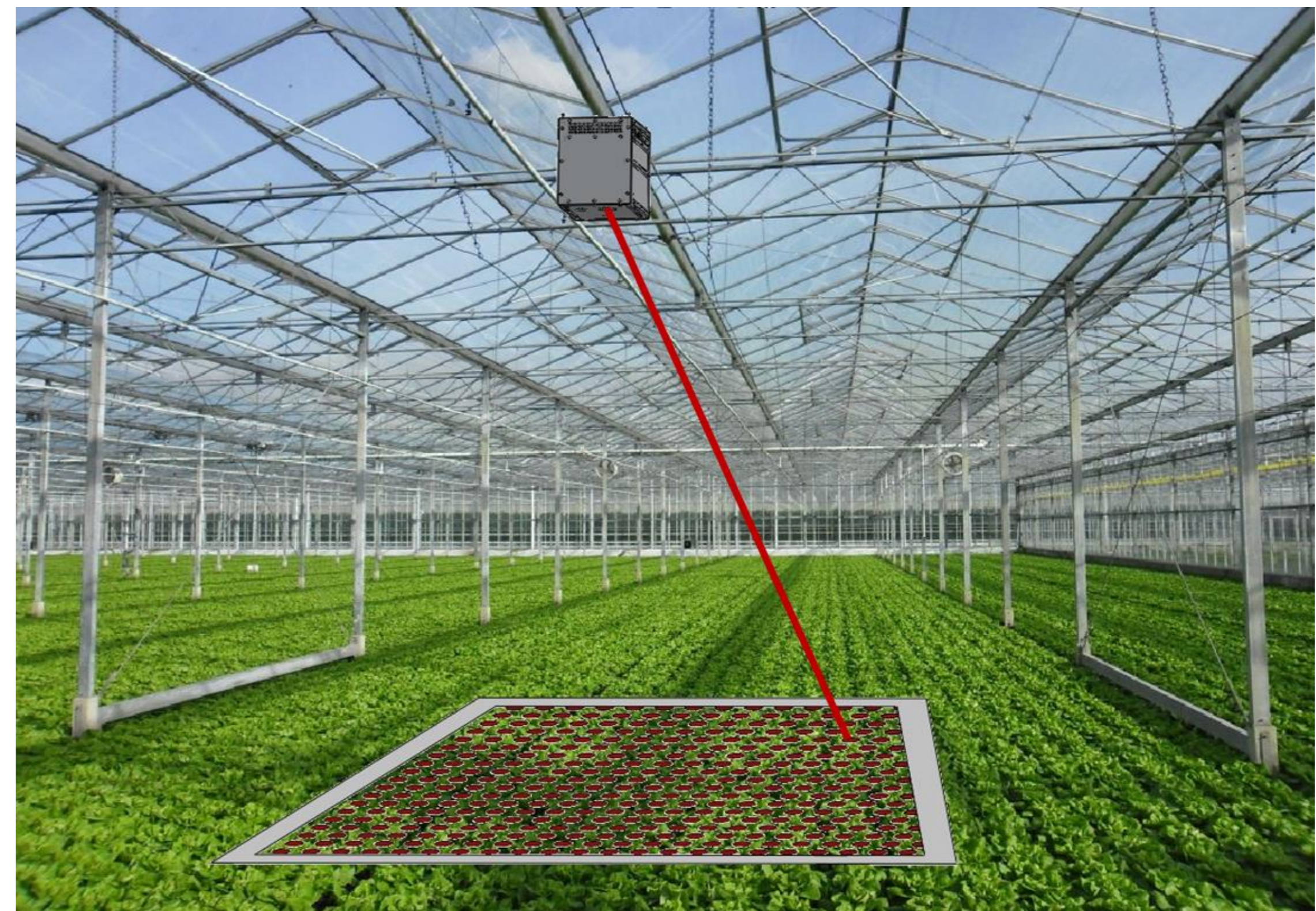
Figuur 2. De CropObserver™ meet op afstand een oppervlakte van 9 m 2 gewas en geeft daarmee een beeld van de efficiëntie van de fotosynthese
