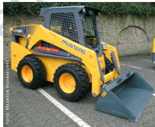
De Mustang skid steer krijgt een extra liftwerking achteraan zodat de laadhoogte met 70 cm verhoogd wordt.
