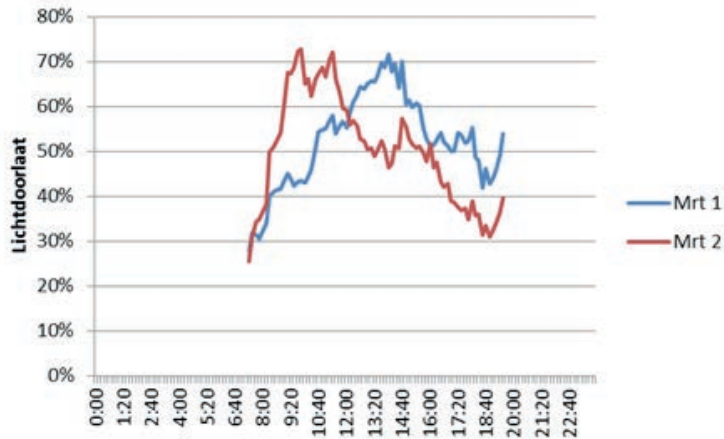
Figuur 23. Cyclisch etmaalgemiddelde van de lichtdoorlatendheid van de kas in maart 2012 gemeten met 1 globale stralingsmeter en 2 PAR meters.
