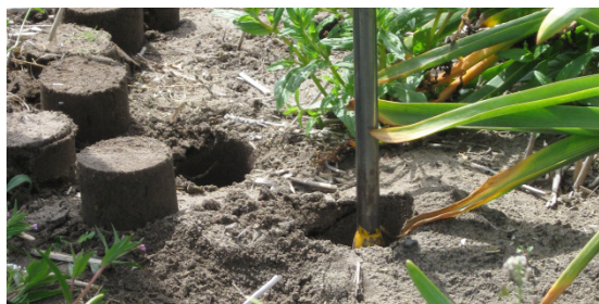
Figuur 1. Het steken van de ringmonsters voor de bepaling van het vocht- en luchtgehalte bij veldcapaciteit ( pF=2 ).
