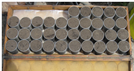
Figuur 1. Het steken van de ringmonsters voor de bepaling van het vocht- en luchtgehalte bij veldcapaciteit ( pF=2 ).
