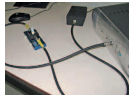
De vereenvoudigde opstelling waarmee Ben Aernouts de melkstalen opmat: lichtbron, melkstaal en Vis/NIR-spectrofotometer.
