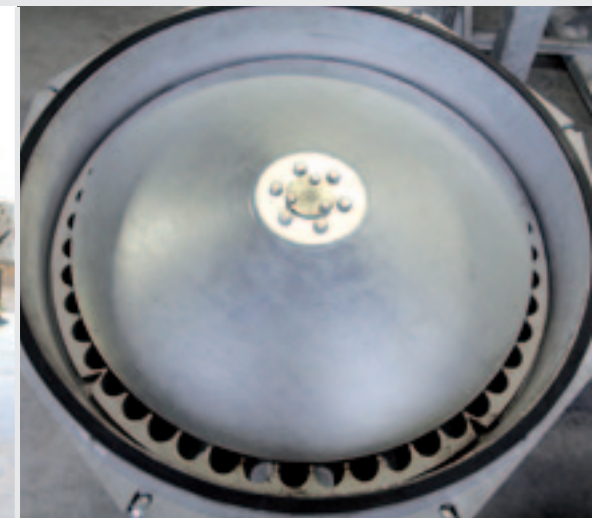
In de verdeelmolen van de Slootsmid-bemester is een excentrische plaat gemonteerd.
