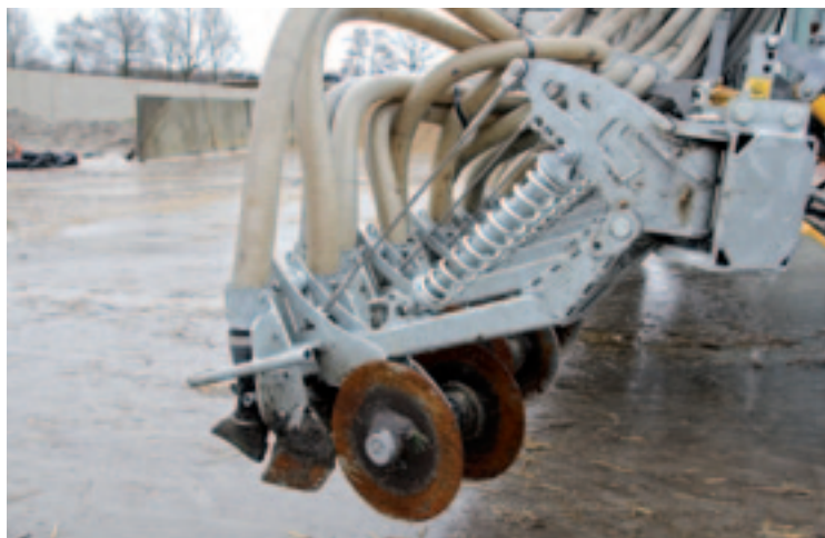
De SZB650 is voorzien van spoorvolgende elementen.
