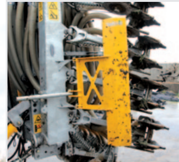
Tijdens het transport schuift er een beschermplaat voor de schijven.
