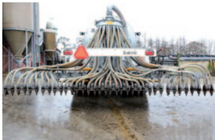
De SZB 650 Standaard in werkstand. De werkbreedte bedraagt 6,50 meter. Er is ook een 5,80 meter brede versie leverbaar.
