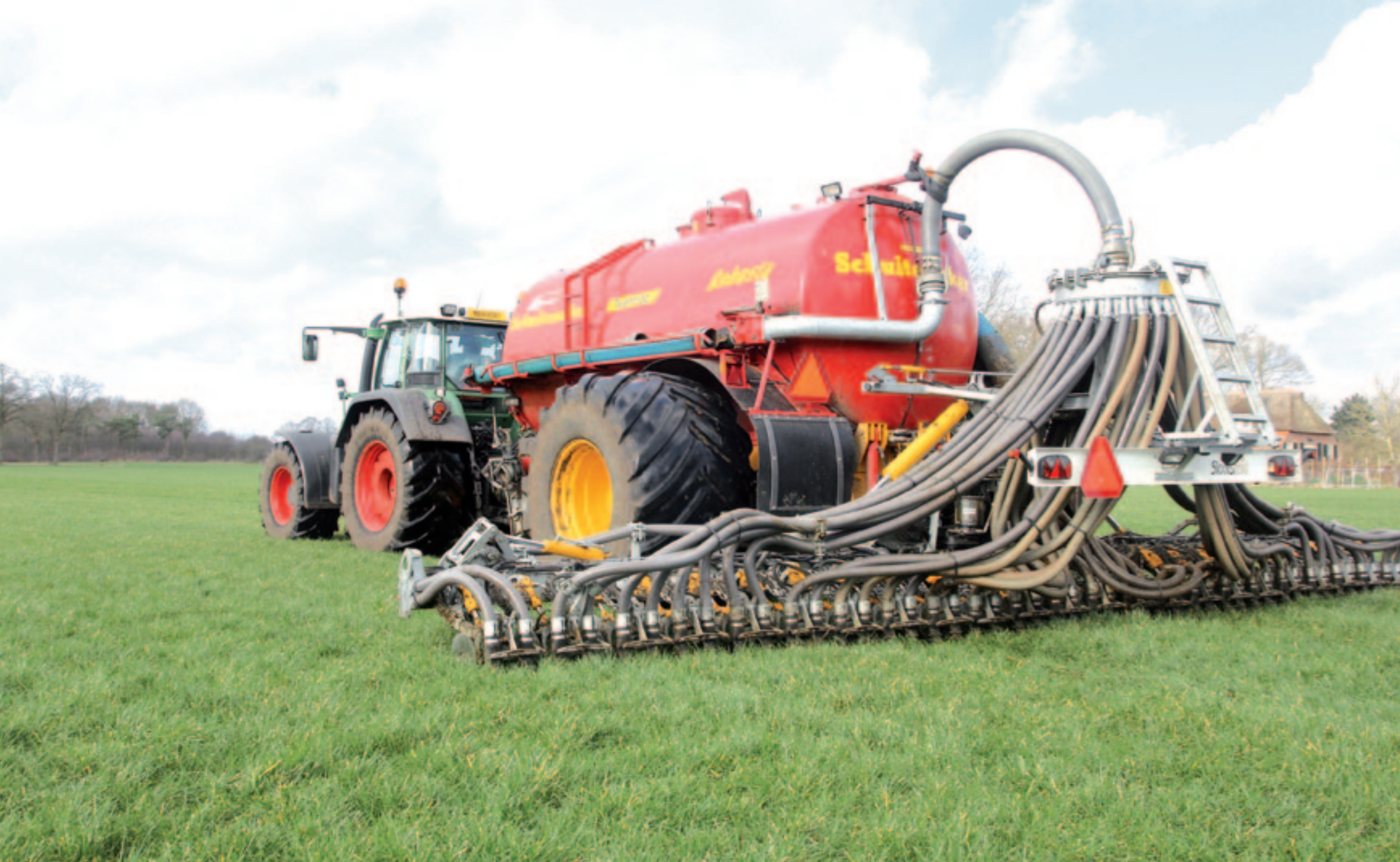
Tijdens het transport schuift er een beschermplaat voor de schijven.
