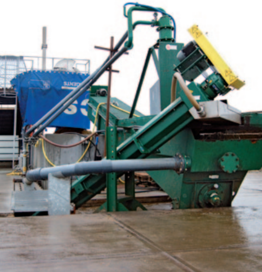
De mestscheider en zandscheider staan achter de nieuwe stal. Dankzij de mestscheiding is er weinig water nodig voor de separatie.
