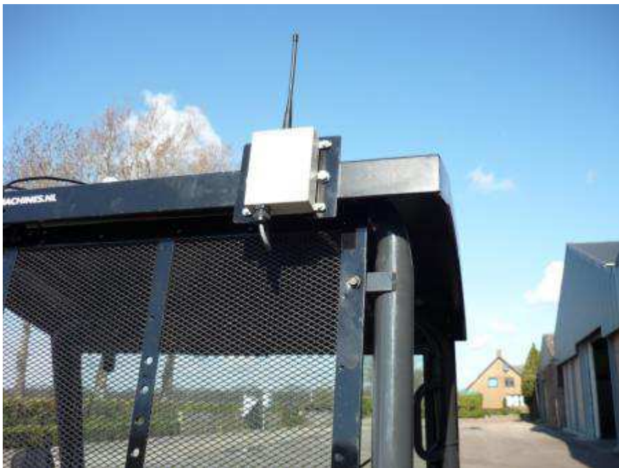
Figuur 17. Ontvanger voor de draadloze noodstop boven aan de dakrand van de cabine.
