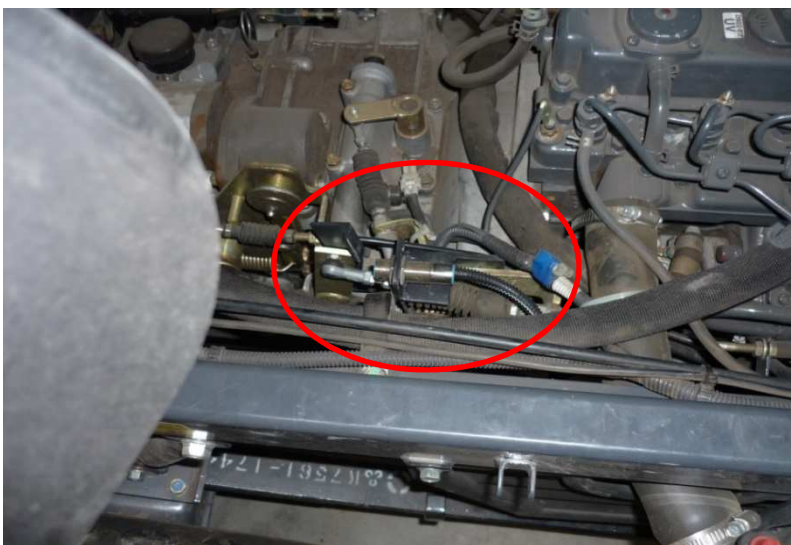
Figuur 16. Inductieve naderingsschakelaar voor detecteren van een eventueel ingeschakelde achteruit versnelling.
