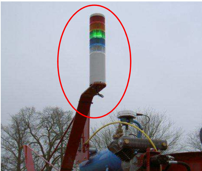
Figuur 5. Status lampen voor zichtbaar maken van de werking van de combinatie trekker/spuitmachine.
