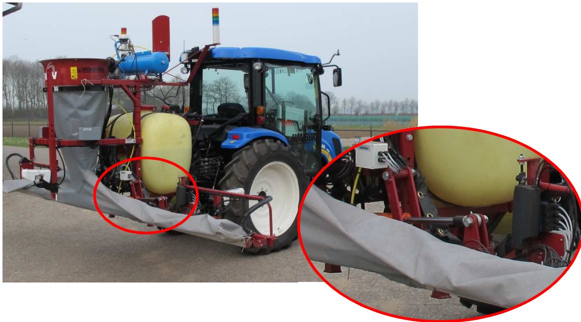
Figuur 22. Hydraulische cilinder voor het uit- en inklappen van de spuitboomsectie.
