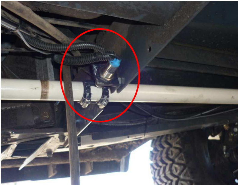
Figuur 15. Sensor voor het meten van het toerental van de aandrijftras naar de wielen van waaruit de rijsnelheid berekend kan worden.
