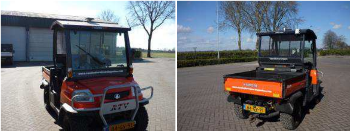
Figuur 12. Voor- en achterzijde van de Kubota RTV900 universeel voertuig die gebruikt wordt voor het voorttrekken van de EM38 sensor.
