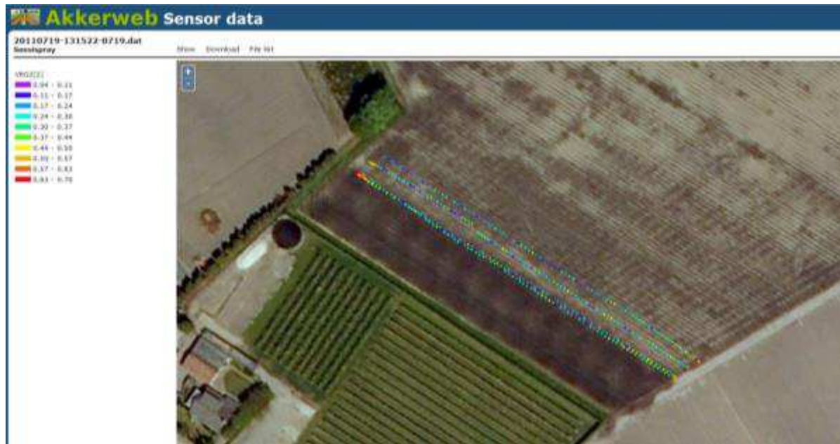
Figuur 20. Voorbeeld van de variatie in de vegetatie index (IRVI) gemeten met de GreenSeeker® sensor opgebouwd op sectie 2 (middelste sectie van de SensiSpray Horti spuit) voor een perceel aardbeien op 19 juli 2011.
