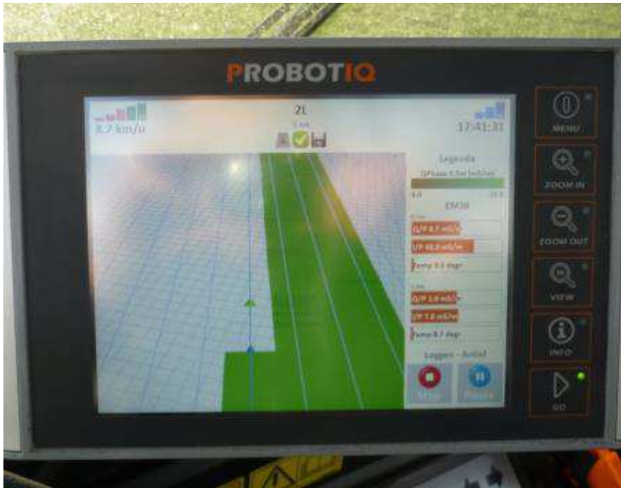
Figuur 18. Weergave van EM38 data gekoppeld aan de GPS data op het touchscreen voor het autonoom laten rijden van het Kubota universeel voertuig.
