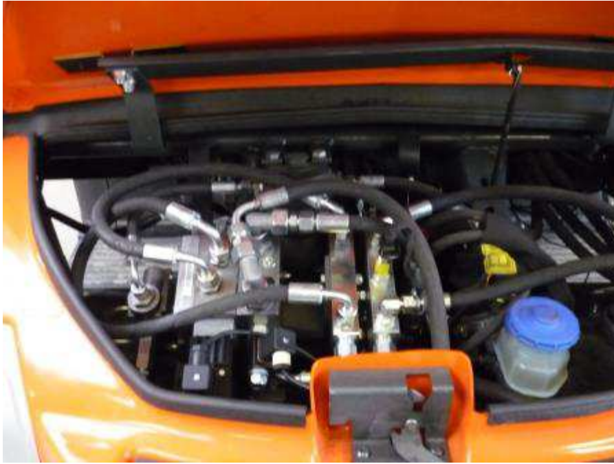
Figuur 13. Hydraulisch ventiel, een prioriteitsventiel en wisselkleppen voor de besturing van het universeel voertuig.
