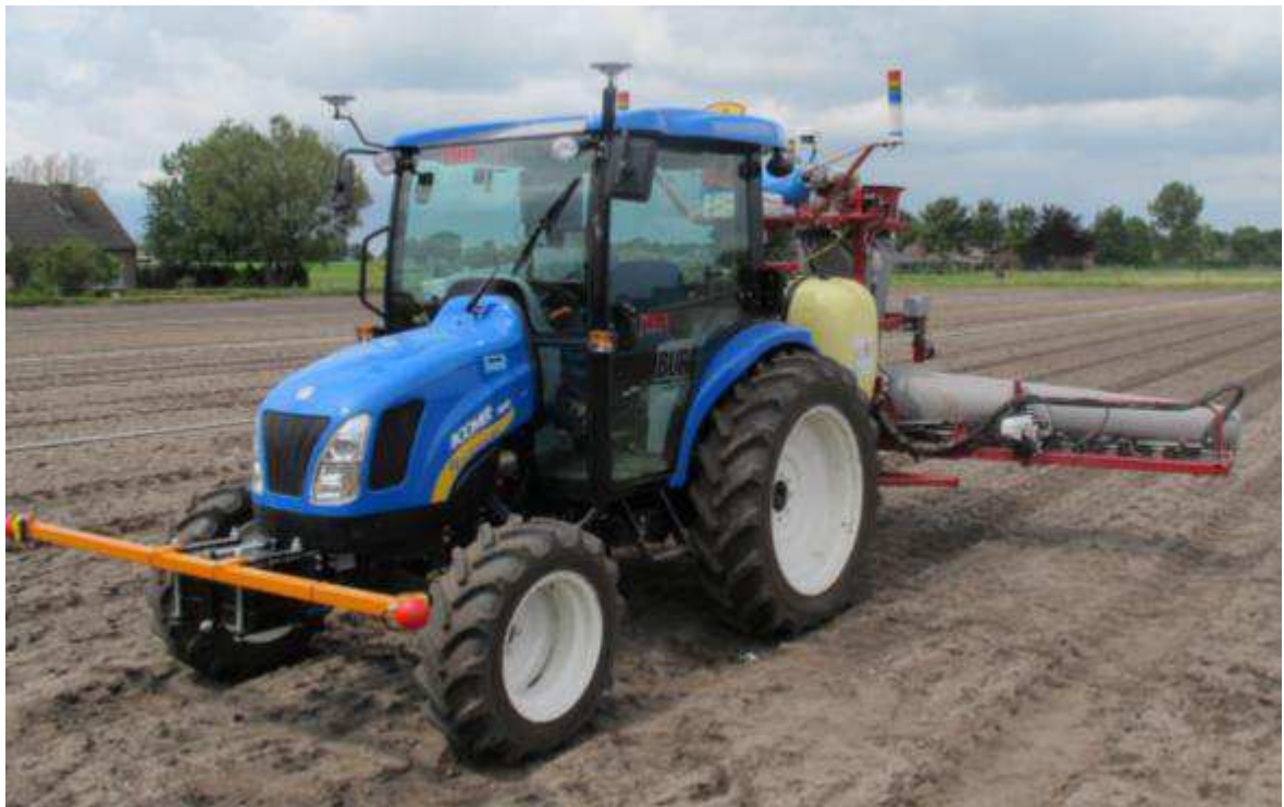
Figuur 1. New Holland Boomer 3050 autonome trekker met Hardi SensiSpray Horti spuitmachine.
