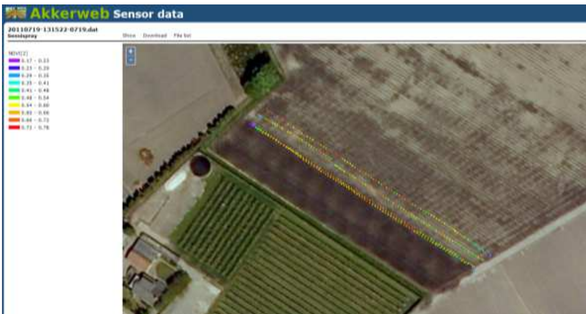
Figuur 19. Voorbeeld van de variatie in de NDVI van de GreenSeeker® sensor opgebouwd op sectie 2 (middelste sectie van de SensiSpray Horti spuit) voor een perceel aardbeien op 19 juli 2011.
