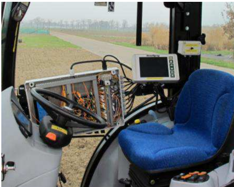
Figuur 4. Interieur van de cabine met de besturingskast (Tractor Control Unit) voor de autonome aansturing.
