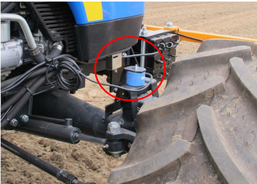
Figuur 2. Stuurinrichting van de trekker met de opgebouwde stuurhoeksensor en begrenzer voor de stuuruitslag.
