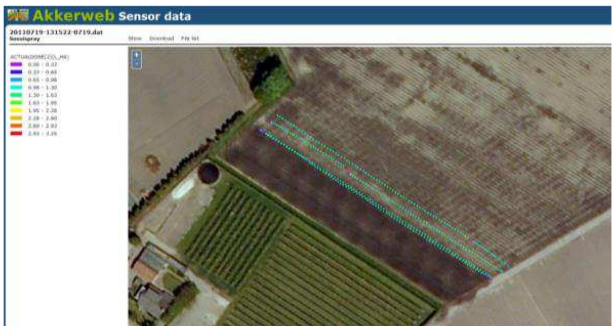
Figuur 21. Voorbeeld van de variatie in de actuele dosis beschermingsmiddel wat wordt gespoten n.a.v. de in Figuur 19 weergegeven variatie in de NDVI onder sectie 2 (middelste sectie van de SensiSpray Horti spuit) voor een perceel aardbeien op 19 juli 2011.
