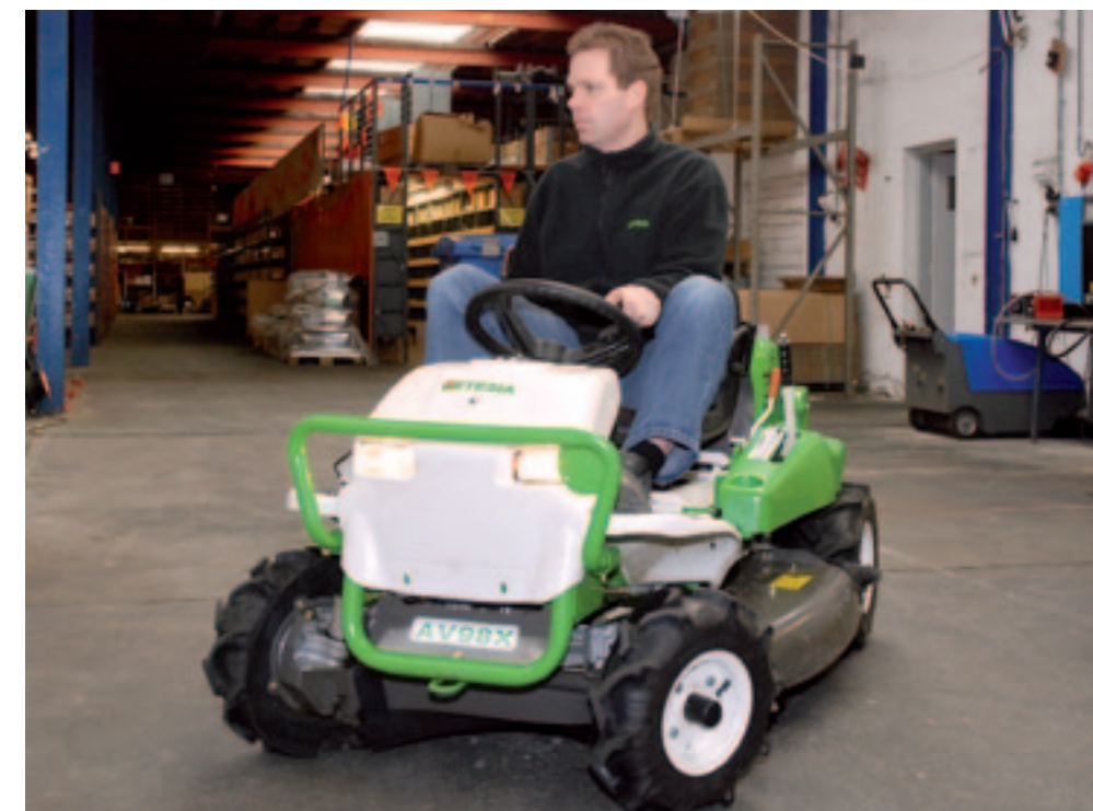
Veel onderhoud aan de ruwterreinmaaier kun je zelf uitvoeren. Onderhoud aan remmen, koppeling en hydraulische aandrijving moet je aan de specialist overlaten.
