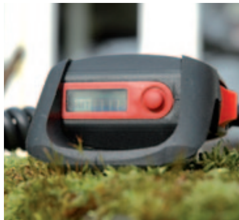
■ Het kleine kastje voor de instellingen en de aan/uit-schakelaar zit vooraan de riem.
