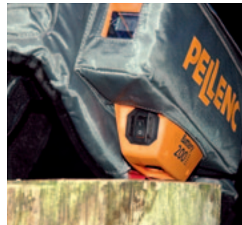
■ De aan/uit-schakelaar zit op de rug onder de accu en is daar minder goed bereikbaar.
