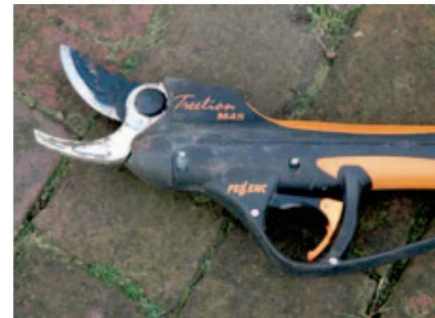
■ De trekker van Pellenc stuurt de knipbeweging aan en (met de gele pal) de grootte van de bek.
