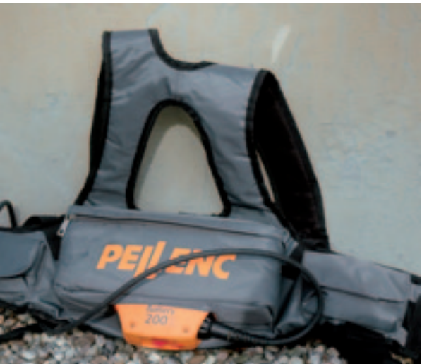
Bij Pellenc zit de accu onderin het draagtuig en rust dus op de heupen. Door het open tuig kan de rug de warmte goed kwijt.
