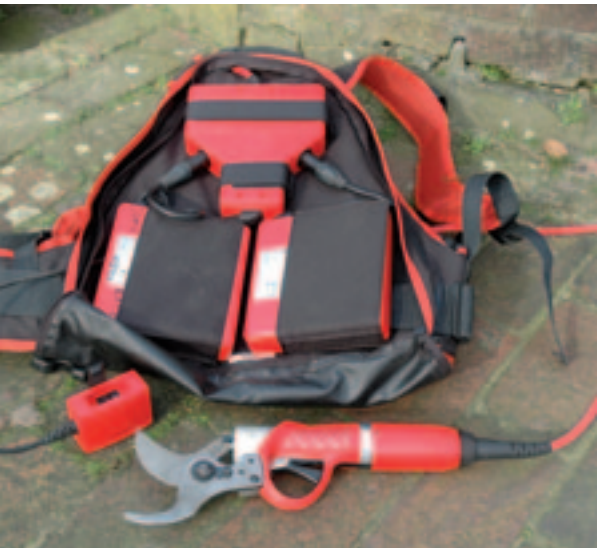
Om te laden moet de rugzak van Felco via ritsen open. De twee accu's zitten onderin met de sturingselektronica daarboven.
