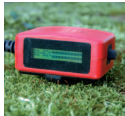
■ Het display toont het laadniveau van de accu's. Met het knopje rechts blader je door het menu.
