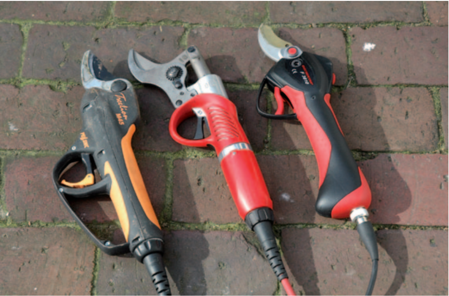
Van links naar rechts de Pellenc Treelion M45, de Felco 820 en de Electrocoup F3010. Elektrisch snoeien op accupower is vooral zinvol bij veel takken tussen 10 en 25 mm doorsnede. Bij takken dunner dan 10 mm is de handsnoeischaar sneller en handiger. Bij normaal hout dikker dan 30 mm heb je toch een zaag nodig.
