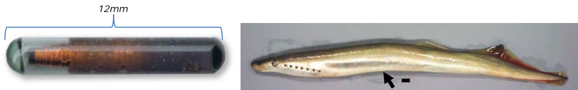
Figuur 4-5 Links) foto van een 12mm HDX PIT tag met een diameter is 2.12mm. In dit onderzoek zijn zogenoemde voorgeladen naalden gebruikt (foto: OREGON RFID). Rechts) een foto met de locatie waar de tags in de buikholte zijn ingebracht (foto: Henk Heessen, IMARES).
