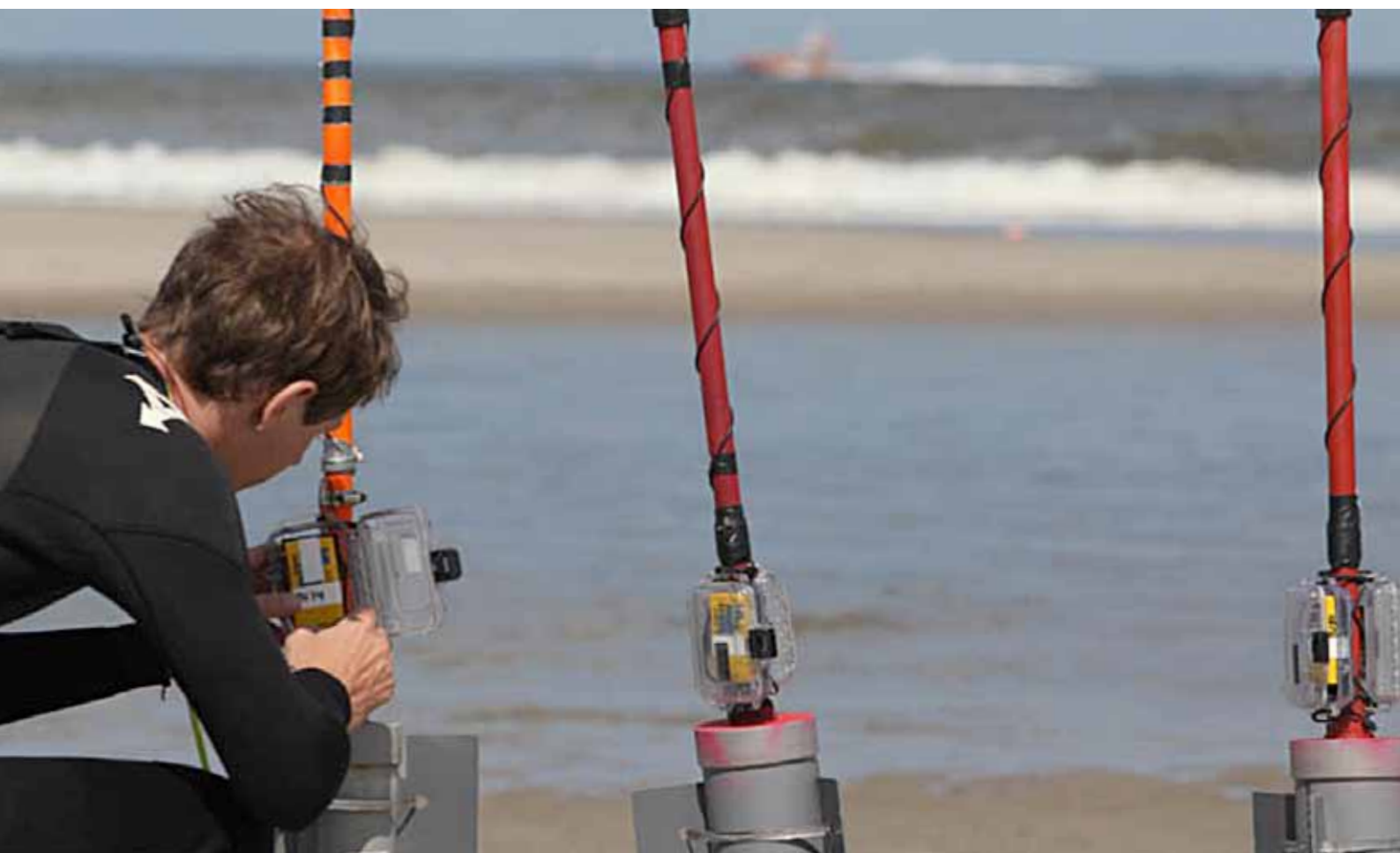
Drifters (meetinstrumenten) worden klaargemaakt voor stromingsonderzoek
