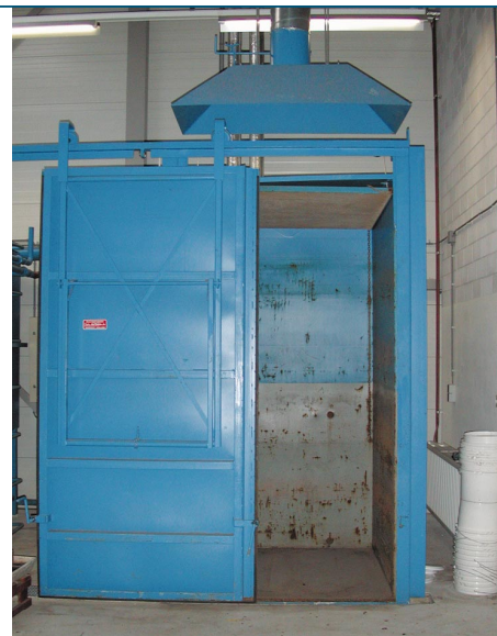
Foto 15. Warmwaterbehandeling in de strijd tegen aaltjes. Foto: PPO Bloembollen
