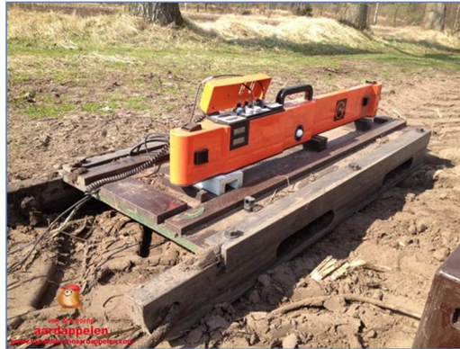
Figuur 3. De EM38MK2 in horizontale coplanaire (of “HCP”) spoelconfiguratie op een metaalvrije slede. Deze slede wordt door een licht terreinvoertuig getrokken en de metingen worden daarbij gecombineerd met GPS en gelogd in een PC.
