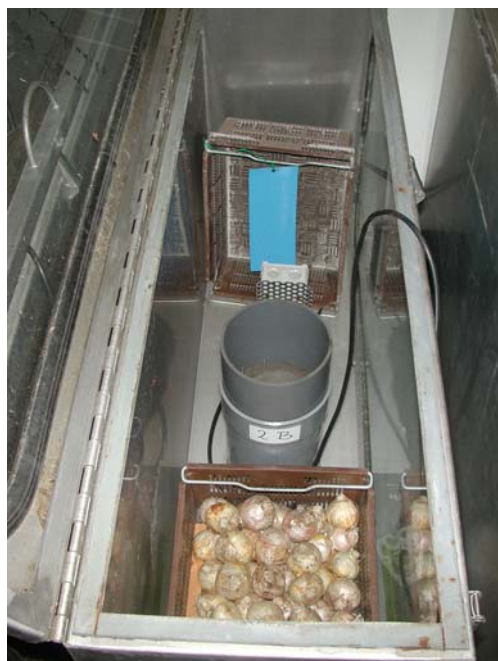
Foto 2: Proefopstelling voor testen beste manier van vangen trips met lijmplaten
