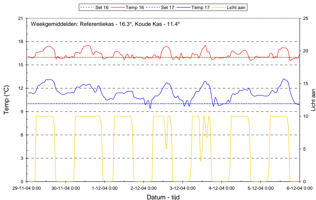
Figuur 2: Setpoints, gerealiseerde temperaturen en perioden dat assimilatielampen aan zijn in de proefkassen in week 49 van 2004.
