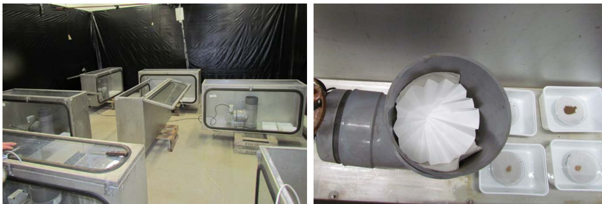
Figuur 20. Opstelling van de proef 'Actellic-ruimtebehandeling in kasten'. Kast waarin de behandeling werd uitgevoerd (links), de ventilator met het filtreerpapiertje waar Actellic op werd aangebracht (rechts) en de schaaljes met mijten (rechts).
