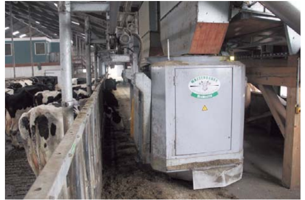
De voerkar rijdt onder de afstort van de voorraadbunker, waarna de opvallend rustig draaiende walsen de gewenste hoeveelheid voer van de kuilblokken af frezen (niet zichtbaar) en in de voerkar deponeren.
