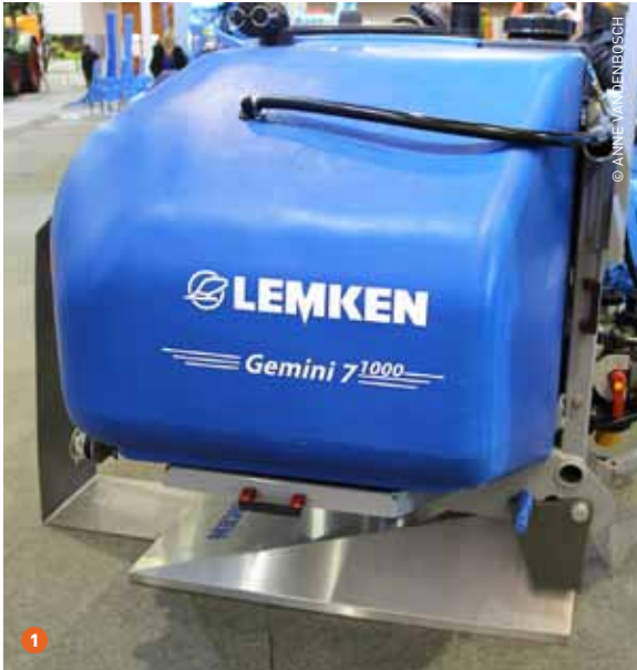
1 De nieuwe fronttank Gemini met een tankinhoud van 1100 l vormt een prima combinatie met een gedragen veldspuit. Het is een goed alternatief voor een getrokken veldspuit. 2 Op Agritechnica werd een prototype van de nieuwe precisiezaaimachine Azurit voorgesteld.
