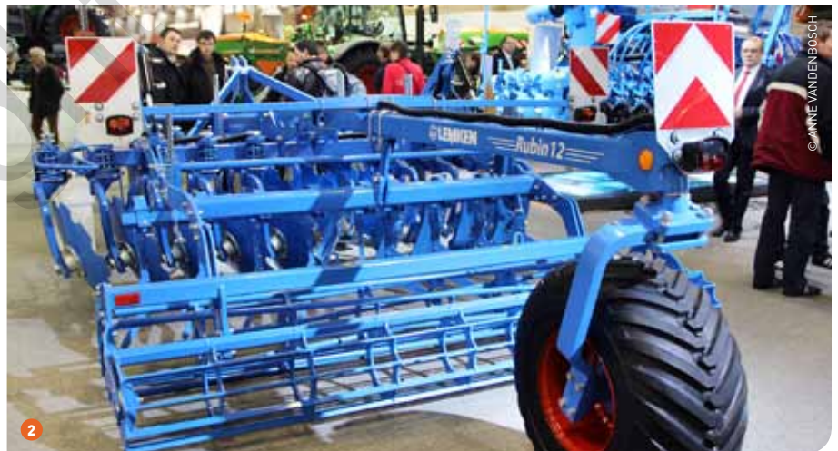
1 Bij aanwezigheid van een spuitspoorschakelaar via gps, of Tramline Control, zal het zaadgoed dat normaal gezaaid moest worden in de spuitsporen via een retourleiding terug naar de zaadtank geleid worden. 2 De speciale vorm van de schijven op de Rubin 12 en de vrije ruimte tussen de rijen voorkomen verstoppingen en asymmetrische slijtage. Het steunwiel achteraan ontlast de wioldruk op de achterwielen van de tractor waardoor structuurbederf op de wendakker wordt voorkomen.
