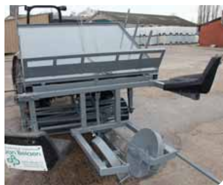
▲ Jan Belaen bouwde een bloemkoolplanter om tot een plantmachine voor bosplanten tot 1,5 m.
