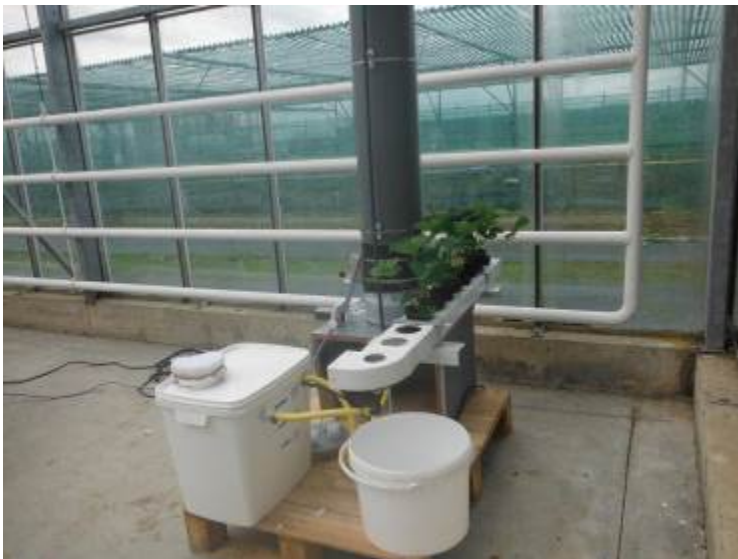
Afb. 14: Opstelling waarmee de effectiviteit van het langzaam zandfilter op afdoding van XF in drainwater is getoetst.
