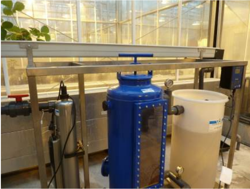
Afb. 13: Opstelling waarmee de effectiviteit van het snel zandfilter + hoge druk UV op afdoding van XF in drainwater is getoetst.
