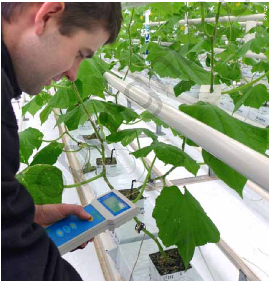
Een Grodan-watergehaltemeter (WGM) meet naast het geleidingsvermogen ook het watergehalte in de substraatmat.
