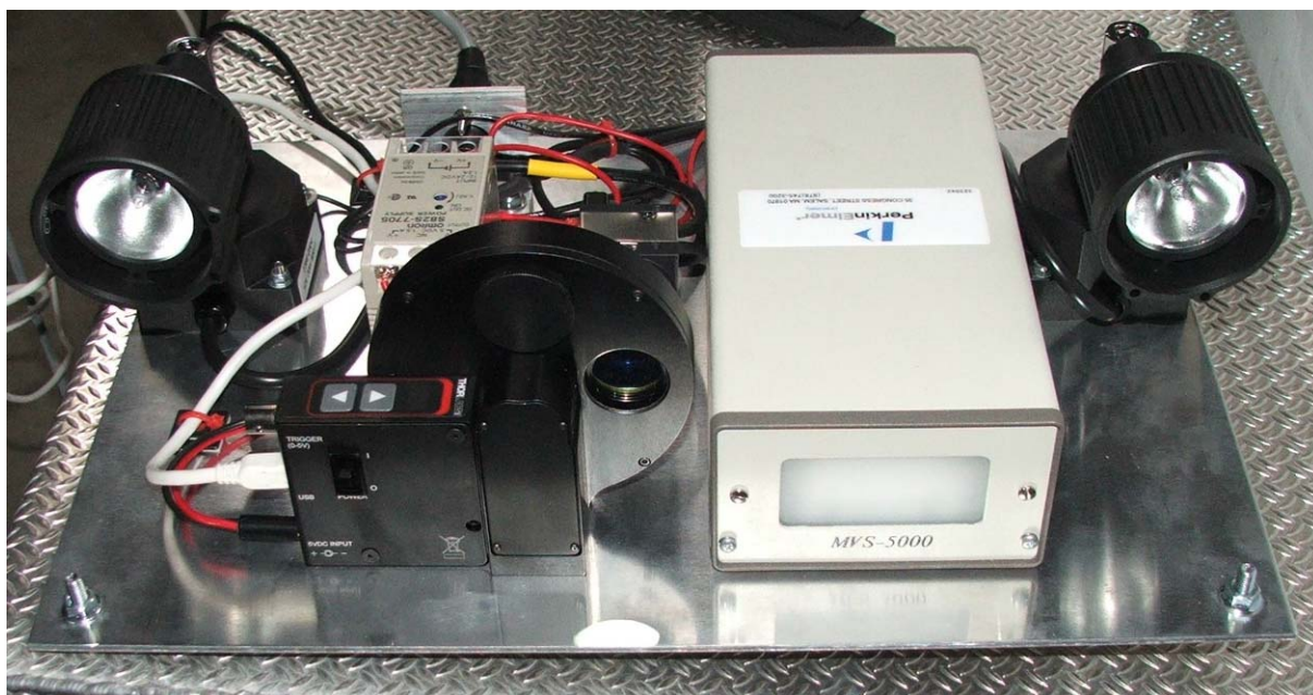
Fig.3. Het camerasysteem met filterwiel, camera, halogeenlampen en flitser zoals geplaatst in de ziekzoekkar.
