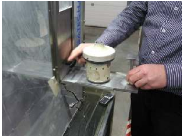
Figuur 3 Gebruik van meetpunt voor monstername met de airsampler
