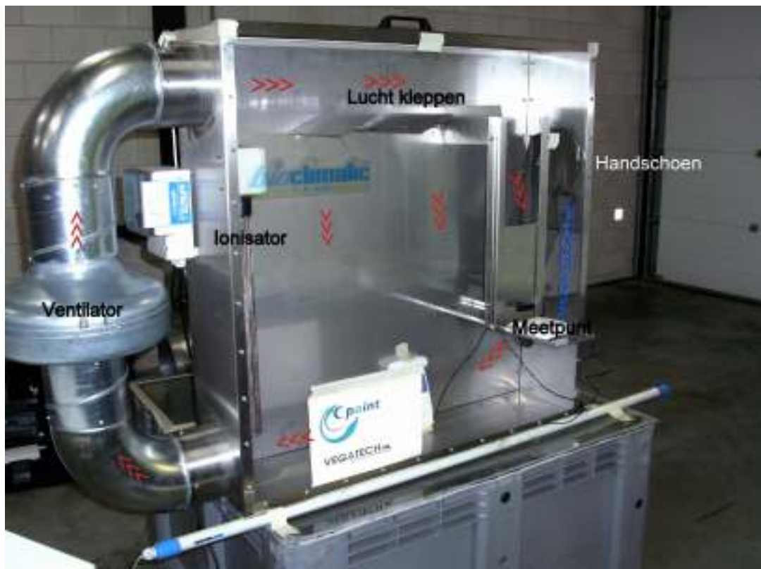
Figuur 2 Testopstelling door middel van de rode pijlen is de luchtstroming weergegeven
