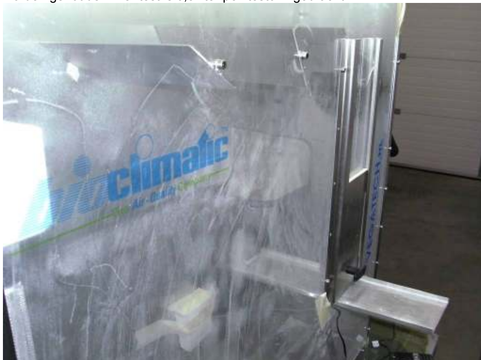
Figuur 7 Testopstelling met daarin perlitestof circulerend
