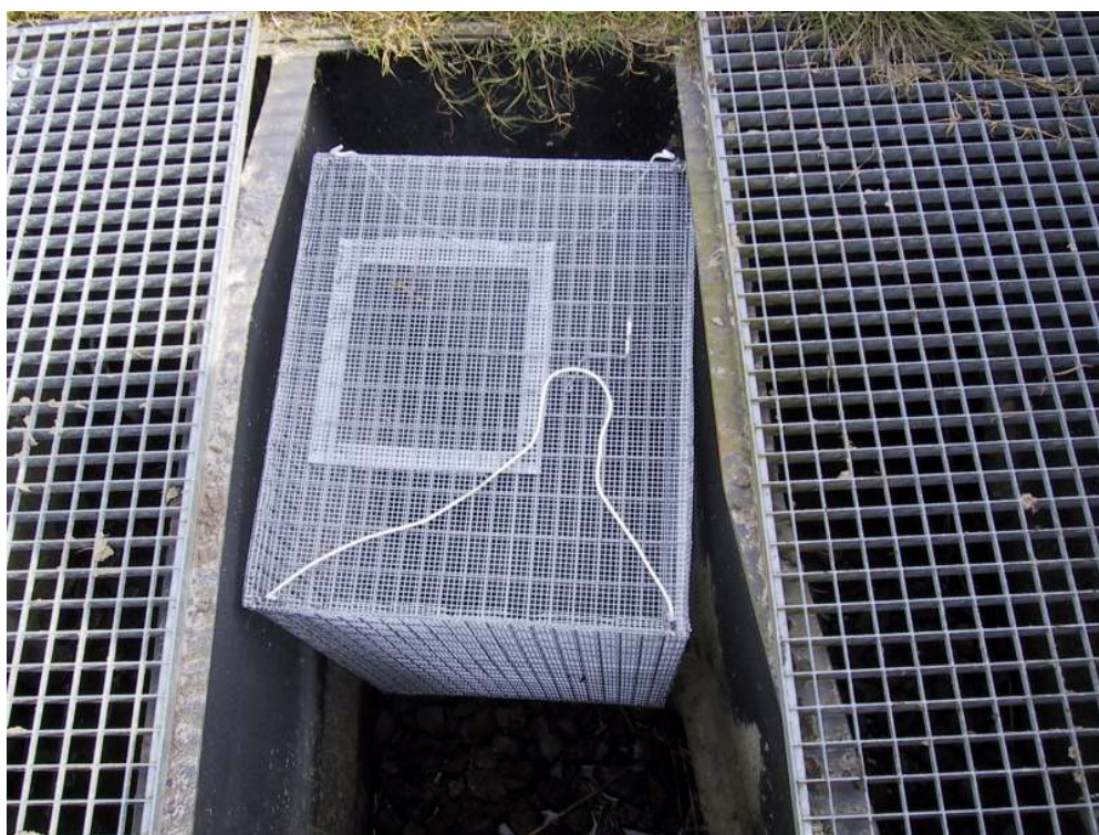
Hokfuik die tijdens de bemonsteringen in 2004 en 2006 in het één na laatste compartiment van de DeWitpassage bij Wier is geplaatst.
