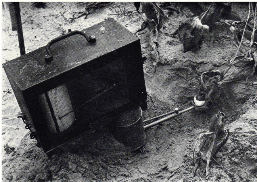
Foto 1. Groeimeter, waarbij het zand is weggegraven, zodat de bol en de band zichtbaar zijn. Aan het einde van het groeiseizoen.
