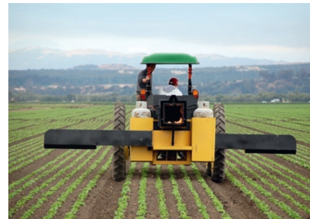
▲ De buitenlucht wordt door de lpg-brander (midden) verhit en door de spleten in de buizen in het gewas geblazen.
