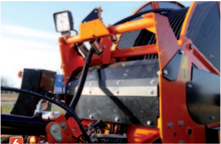
[4] Een slangenhaspel voor de zuigslang is een handig extraatje. De slang is 10 meter lang.
