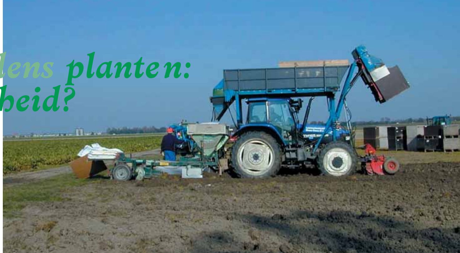
Nettenplanter. Ruimte voor inbouw van een dompelunit met uitlekplaats is mogelijk te vinden tussen de voorraadbunker op het dak van de tractor en de voorraadbunker van de plantunit.
