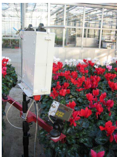
Afbeelding 3. Datalogger meetbox en infrarood camera
