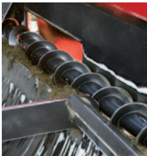
De vijzel brengt het voer naar de losopening.
