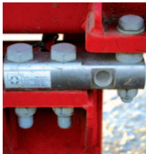
De bak wordt standaard gemonteerd op zes weegcellen.
