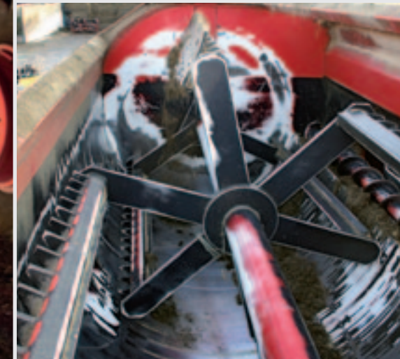
Door de grote 'peddel' wordt het voer luchtig gemengd.
