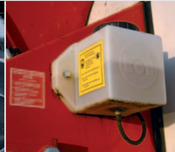
De Redrock beschikt over een automatisch smeersysteem.
