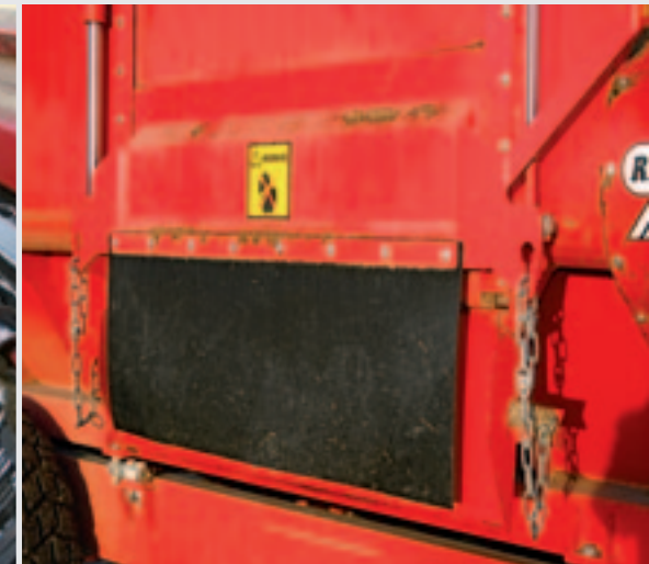
Openingschuif die hydraulisch bediend wordt.
