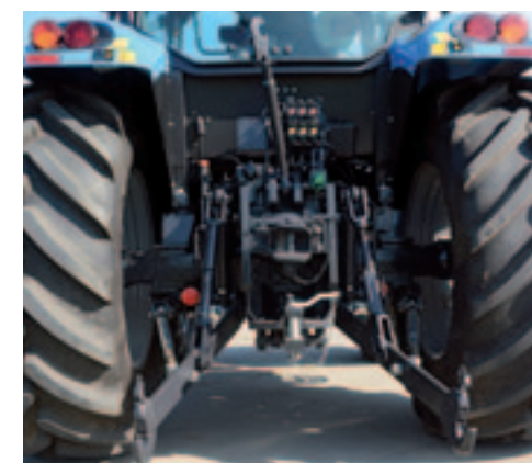
De Landini Power Mondial 120 heeft drie dubbelwerkende ventielen. De hef tilt 4.450 daN.
