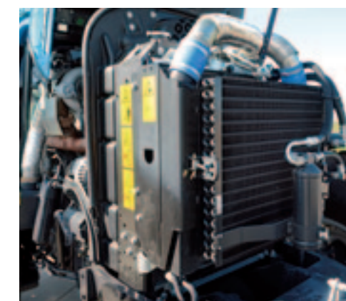
De 4,4 liter Perkins heeft een turbocompressor en een intercooler en een elektronisch geregelde inspuiting. Die zorgt voor een boost in vermogen.
