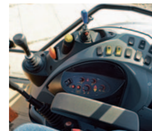
De gehele bediening van de trekker zit op het rechterconsole. De bediening van de hef en is afkomstig van Bosch.
