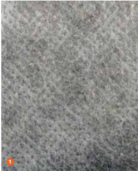
1 Vliesdoek is het goedkoopste afdek materiaal.
