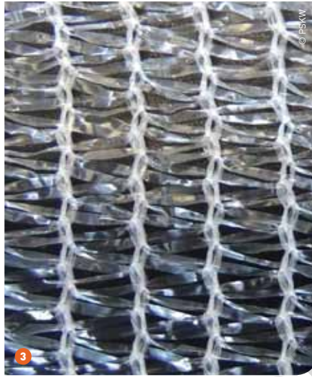
2 Klimaatdoek is gemaakt van een polyethyleen bandjesweefsel.
