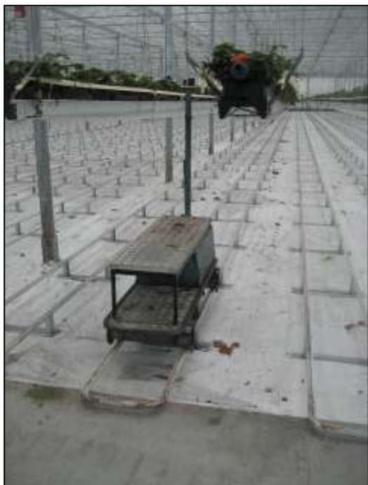
Figuur 3.2: Elektrische buisrailwagen met in hoogte verstelbaar werkplateau
