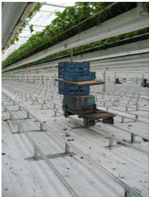
Figuur 4.1: Elektrische buisrailwagen met oogstplateau.
