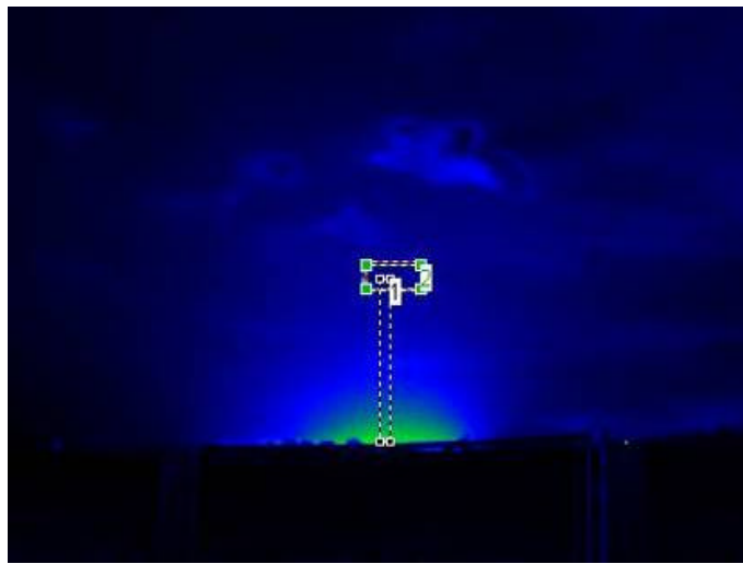
Figuur 4.3 - Beeld van de luminantiecamera bij locatie Stompwijk, gezien vanaf A4. Rechthoek 1 geeft aan over welk gebied de L0-L15 bepaald wordt. Rechthoek 2 geeft L15 aan.
