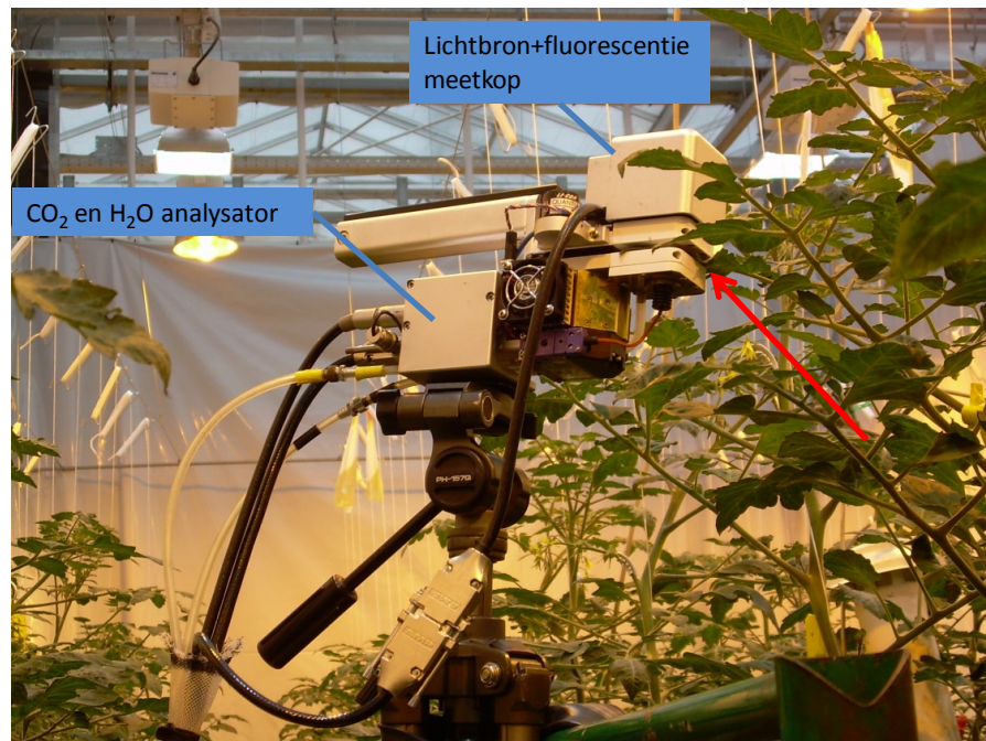
Foto 1. LI-COR-6400 draagbare fotosynthesemeter voor het meten van de CO 2 opname (fotosynthese) in de praktijk. In het apparaat kunnen PAR, CO 2 , temperatuur en vocht gevarieerd worden. Op deze manier is de fotosynthese-snelheid gemeten bij oplopend PAR of CO 2 aan een ingeklemd blad (rode pijl).
