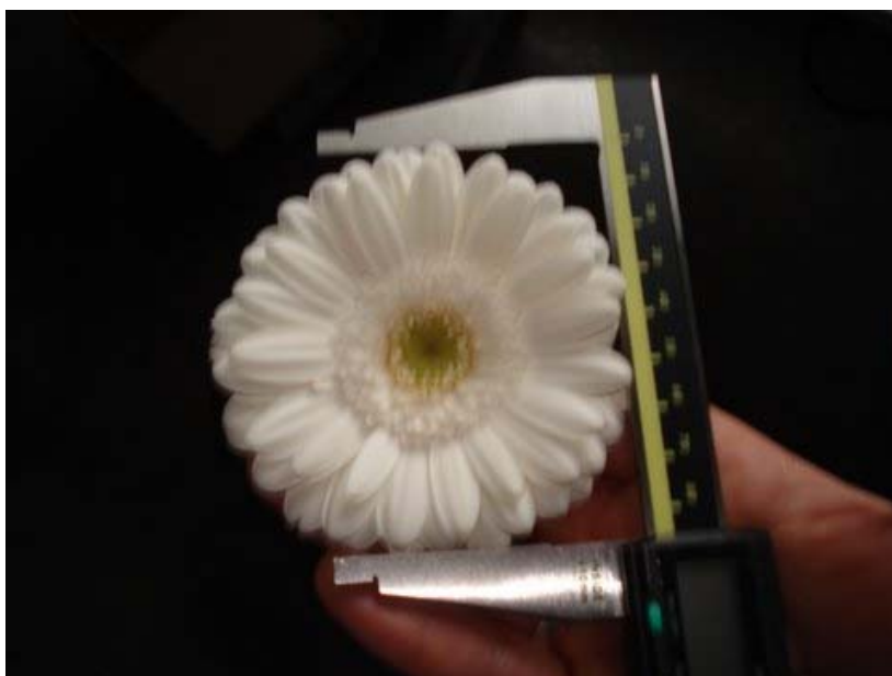
Foto 6. Diameterbepaling met behulp van een digitale schuifmaat
