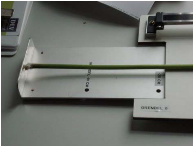
Foto 4. Steellengtebepaling met behulp van een digitale lengtemeter.
