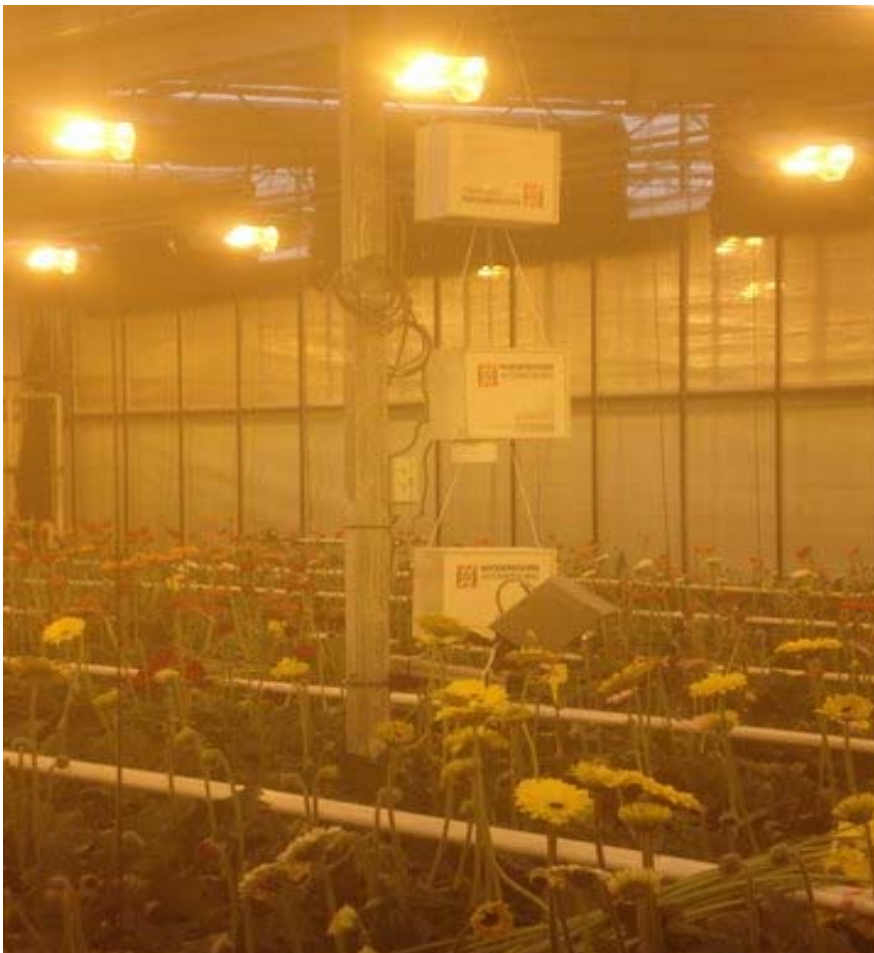
Foto 5. Meetpaal met 3 meetboxen, PAR meter, elektronische CO 2 meting en IR camera
