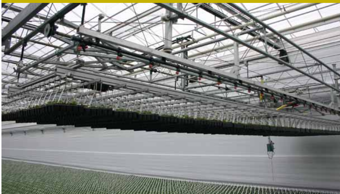
Een medewerker pakt met een overgewaswagen met haken de planten aan de draagbeugels op en zet deze op de gewenste plek in de kas weg.
