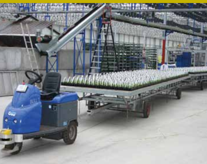
Na het oppotten gaan de planten met een onbemande trekker met twee karren naar de kas.
