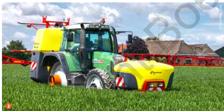
1 De Optima TF maxi wordt centraal gevuld. Gedaan met 16 bakjes apart te vullen. De aanvoer kan nu met bigbags. 2 Met de iXtra-fronttank maakt de teler een zelfrijdende spuitmachine met grote capaciteit en goede rijeigenschappen.
