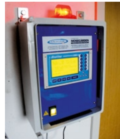
De Heatime besturingskast is voorzien van een lamp die knippert zodra een koe meer activiteit vertoont dan normaal.
