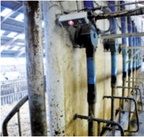
De antenne bij de ingang van de melkstal ontvangt per infrarood alle gegevens van de koeien.
