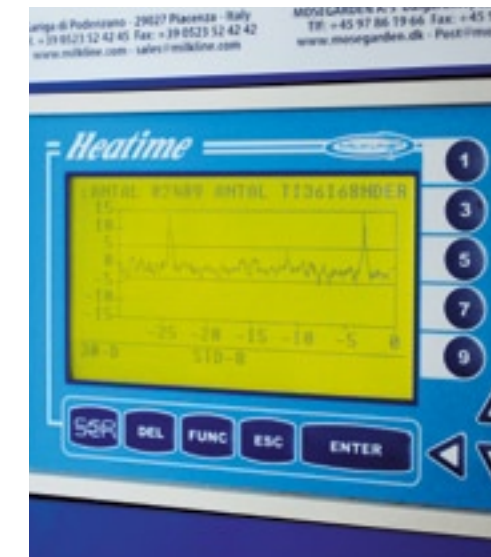
Op het display is naast de lijst attentiekoeien ook een grafiek van de activiteit van alle dieren te zien. Hoe hoger de pieken, hoe hoger de activiteit.
