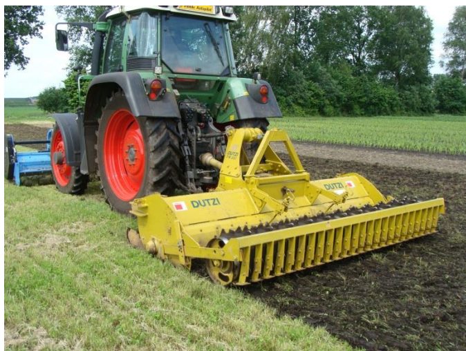
Figuur 5. Inwerken van de grasklaver met een hakenfrees
