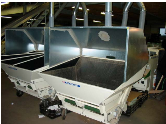
figuur 6: puntafzuiging - cycloonseparatie
